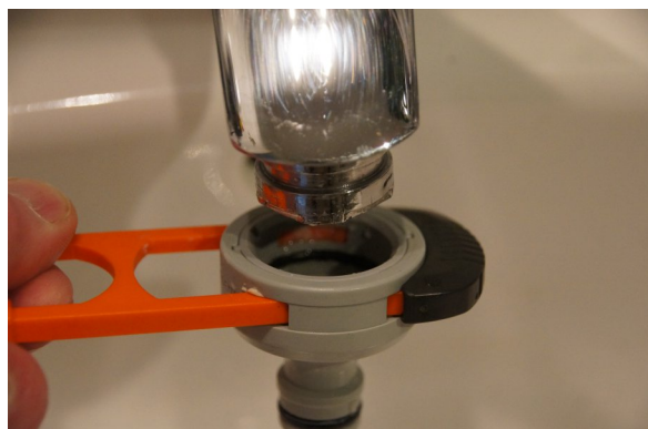
oben: Das Aufstecken ist sehr einfach unten: Der Schlauchanschluss im arretierten Zustand
