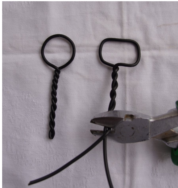
unten: Einkürzen des Schafts, die eckige Form kann über den Daumnagel gefort werden
