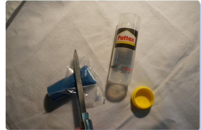
Aus der Stange wird je nach Bedarf ein Stück abgeschnitten. Der helle Kern der Stange muss mit dem blauem Mantel kräftig durchgeknetet werden, damit sich die beiden Komponenten gut vermischen.
