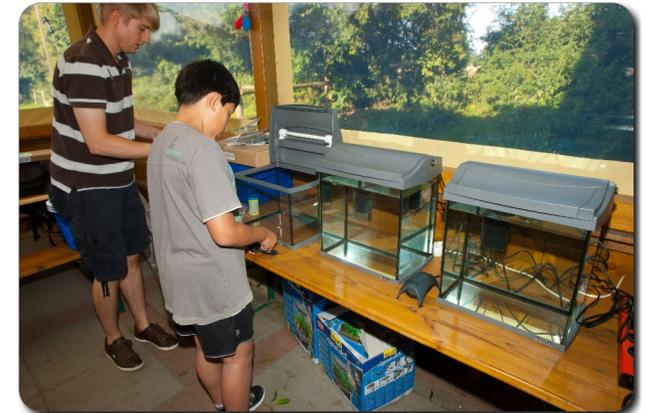
Die beiden Versuchsaquarien für die Untersuchung des Ammoniakabbaus durch Filterbakterien sind eingerichtet. Um die Untersuchung nachvollziehbar zu halten, wurde auf eine Einrichtung verzichtet. Tiere wurden natürlich auch nicht eingesetzt.
