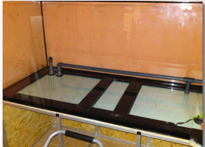
Part V: Verkleben der Seitenscheiben und der Längs-, sowie Querstreben
