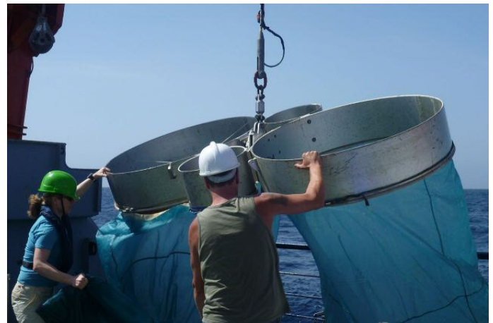
Ausbringen eines Planktonnetzes vom Forschungsschiff POSEIDON aus. Foto: Benjamin Kürten, IFM-GEOMAR
