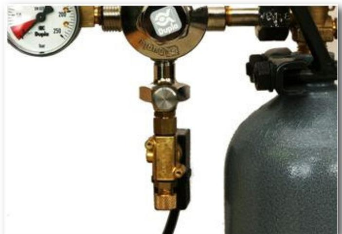
*Anschluss des Magnetventils*
